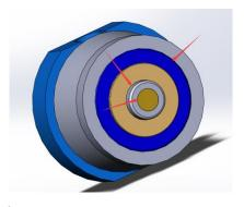
4、外观要求:磁铁外圈 R 角小于 0.2mm
