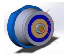
3、外观要求:磁铁与胶件,铜套与胶件,铜柱与胶件之间无缝隙,并且铜套压紧磁铁
