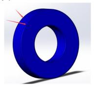
5、尺寸要求:后盖与主体紧密接合,无缝隙,不溢胶
