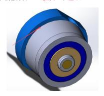
6、灌胶要求:使用透明的 UV 胶填充,必须封住所有焊点和线,但胶料不得凸出后盖
