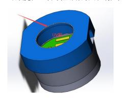
7、线材要求:4C 线, 护套 OD2.5mm, 护套必须插入约 3mm, 如图最佳
